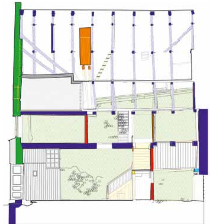
■ um 1385 ■ um 1750 ■ bis 2. WK ■ um 1425 ■ um 1850 ■ ab 1945 bis heute ■ um 1650 ■ um 1900 □ Unbestimmt ■ 2. Hälfte 17. JH Längsschnitt
