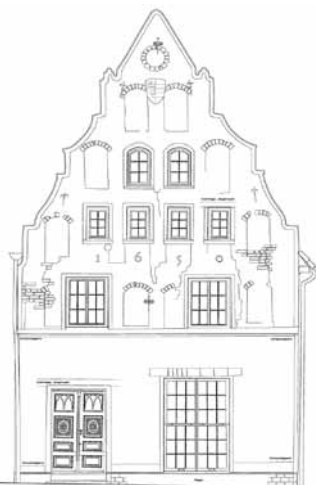
Nordfassade nach Putzentfernung, Darstellung der freigelegten Gliederung des Giebels
