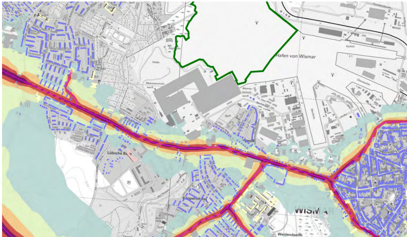
Anhang 1.2 Rasterlärnkarte der Immissionssituation für die untersuchten Straßenabschnitte für den Zeitbereich DEN (Ganztageswert über die Zeitbereiche Tag(day), Abend(evening) und Nacht(night)) in 4 m über Grund. Darstellung der Isophonen in 5-dB(A) Pegelschritten.
