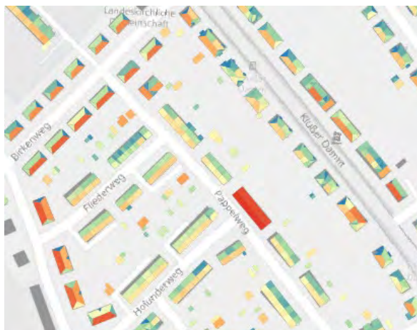
Abbildung 60: Detailausschnitt Dachformanalyse via LoD-2 Daten, Wismar Süd, Quelle: DSK GmbH
